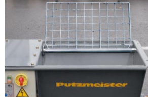
La rejilla de seguridad se puede abrir de forma amplia. Así se facilita el acceso al cono (p. ej., para limpiarlo).
