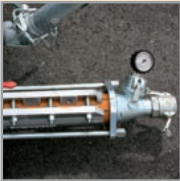
La potente bomba sinfin 2L6 con manguito de presión para conectar la manguera.
