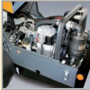
El número de revoluciones máx. del motor, de solo 2.600 r.p.m., y su óptima insonorización hacen de la SP 11 una máquina especialmente silenciosa.
